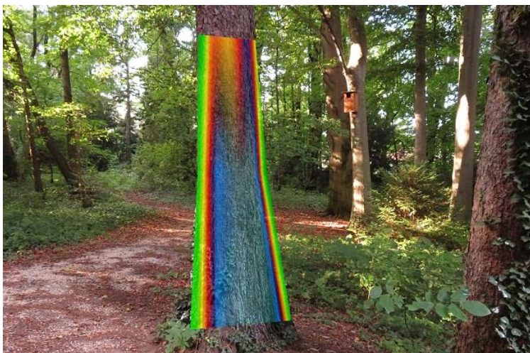
7. kép ArborSonic 3D Akusztikus Tomográf vizsgálat eredményének rávetítése a vizsgált törzsre
